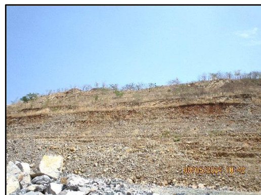
ภาพที่ 2.8 การนำเศษหินและเศษดินทำคันดินสำหรับปลูกต้นไม้บริเวณพื้นที่ที่ผ่านการทำเหมือง
