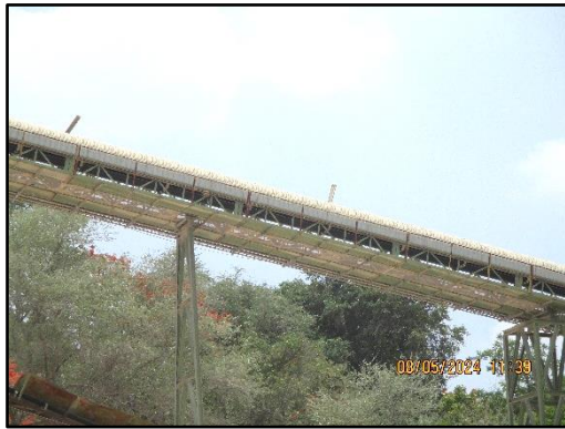
ภาพที่ 2.19 สายพานลำเลียงหินเป็นแบบปิด
